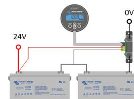
In un banco batterie in serie/parallelo può essere utile per collegare i punti medi di ogni stringa parallela/serie. La ragione per cui farlo è quella di eliminare lo sbilanciamento interno del banco batterie.
