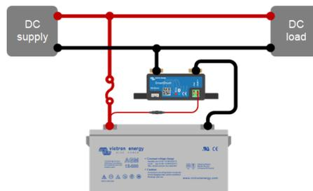
L'errata collocazione dello shunt può causare problemi, soprattutto nei sistemi di grandi dimensioni che prevedono un lungo percorso tra la batteria e gli inverter/caricabatterie. Durante l'inversione, l'inverter/caricabatterie vicino allo shunt "vedrà" una tensione di ingresso CC più bassa rispetto a quelli più lontani. Viceversa, durante la carica, le batterie vicine allo shunt "vedranno" una tensione di ingresso CC più bassa rispetto a quelle più lontane. Vedere le immagini sottostanti.
