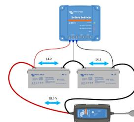
Se il battery balancer non ottiene l'effetto desiderato e la differenza di tensione diventa maggiore di 0,2 V, lo sbilanciamento della batteria supererà il limite entro il quale può essere corretto dal battery balancer. Questa è verosimilmente un'indicazione del fatto che una delle batterie ha sviluppato un guasto e il Battery Balancer farà saltare un allarme e attiverà il suo relè di allarme.
