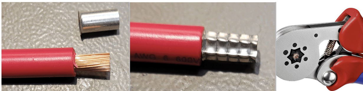
Puntalino a bussola crimpato in modo esagonale
