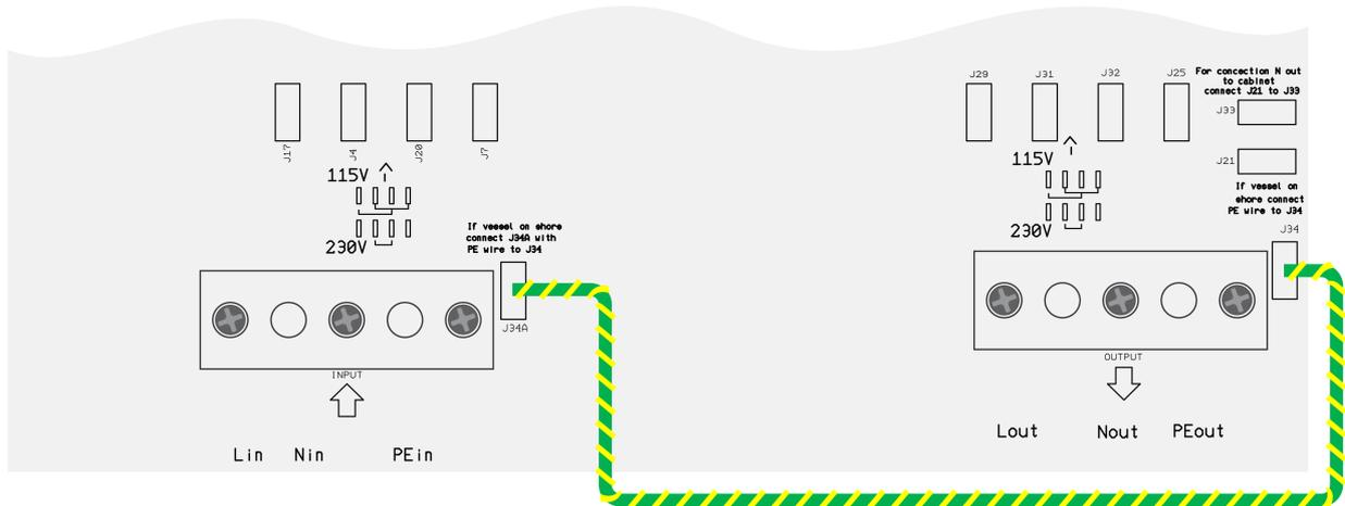
La messa a terra dell'ingresso CA è collegata alla messa a terra dell'uscita CA quando l'imbarcazione è fuori dall'acqua (a terra) durante l'inverno o per la manutenzione.
