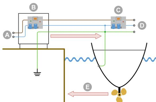
*La messa a terra di banchina collegata ai metalli immersi dell'imbarcazione provoca la corrosione galvanica.*
