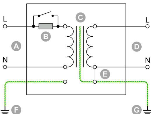
Schema di cablaggio interno del trasformatore di isolamento.
