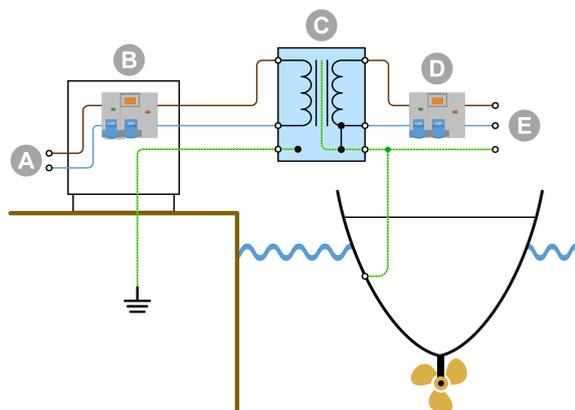
La messa a terra di banchina è isolata dalla messa a terra dell'imbarcazione e la corrosione galvanica proveniente dal collegamento di banchina è bloccata.
