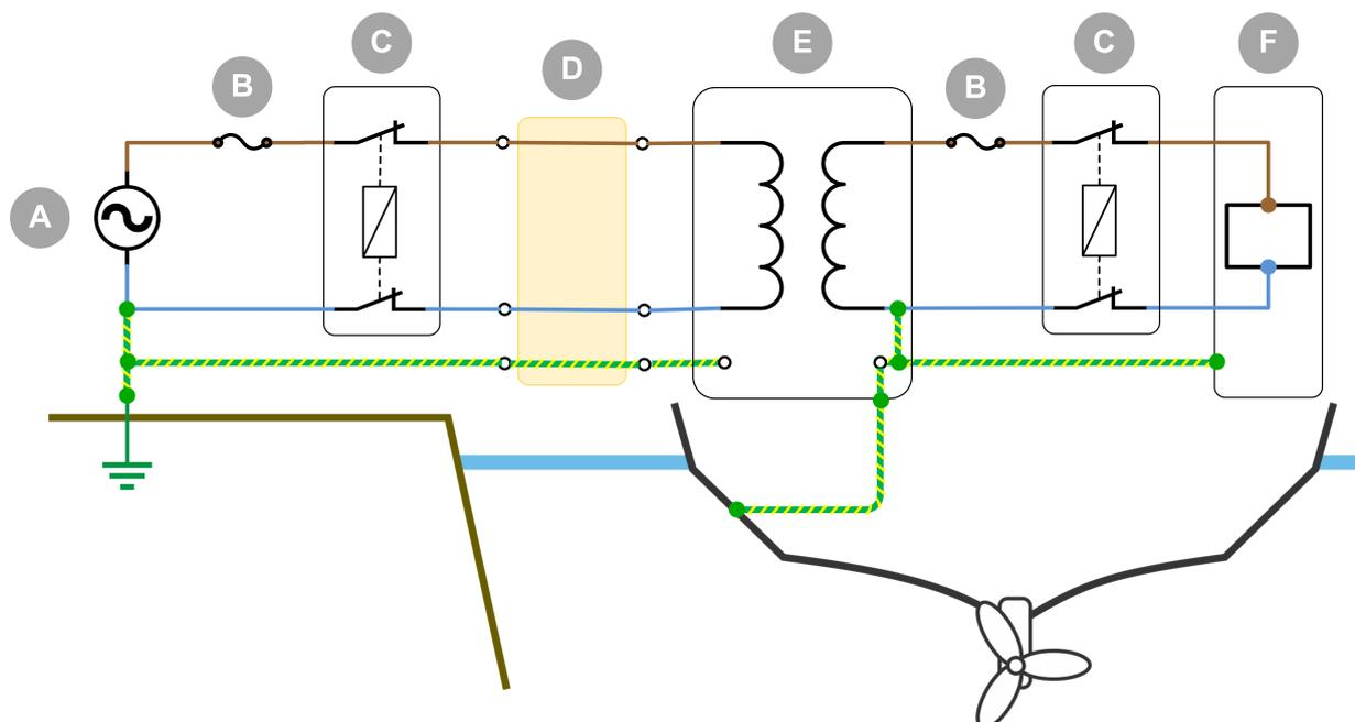
Esempio di cablaggio di un trasformatore di isolamento installato in un'imbarcazione collegata all'alimentazione da banchina.
