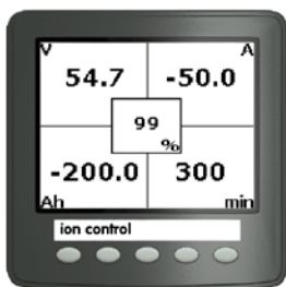
Ion control: Schermata principale
