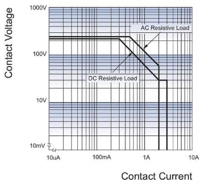
Potenza di commutazione dei contatti a relè di chiusura in base a tensione e corrente
