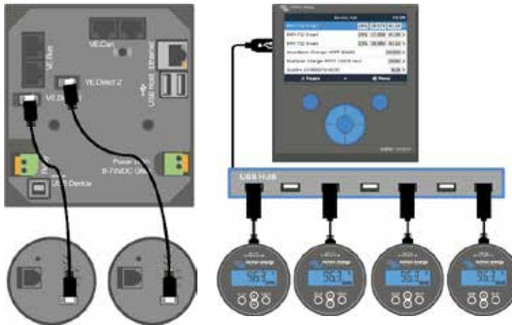
È possibile collegare direttamente un massimo di BMV a un Color Control GX. Ulteriori BMV possono essere connessi tramite Hub USB per un controllo centralizzato.
