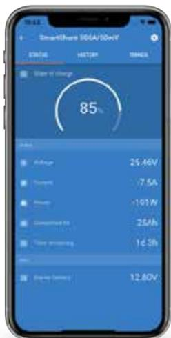
Lo SmartShunt è un monitor della batteria tutto in uno, ma senza display. Il vostro telefono funge da display.
