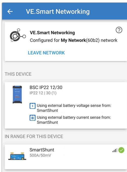
17. Per i sistemi con caricabatterie aggiuntivi compatibili con il VE.Smart Networking collegati alla stessa batteria/banco batterie, ripetere i passaggi 8-16 per includere ogni caricabatterie rimanente nella rete VE.Smart comune.
